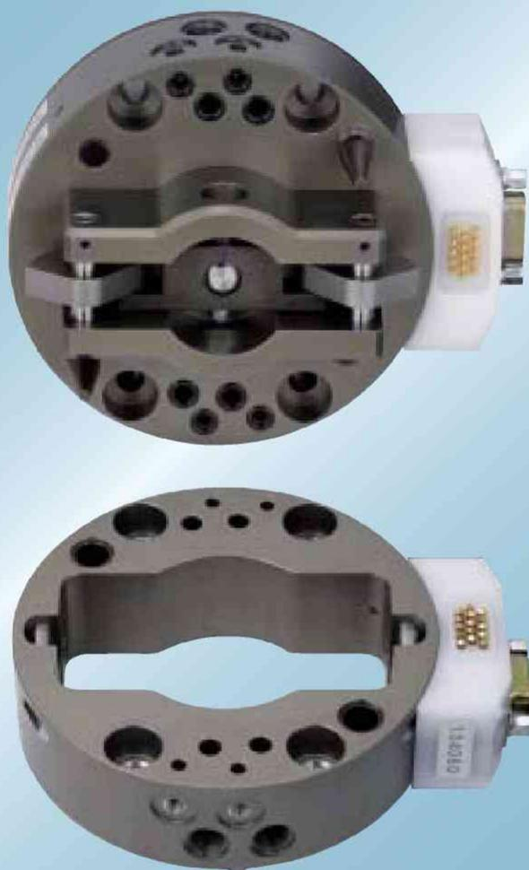
ニッタ チェンジシステム「XC-30」は大口径シリンダと独自のカムロック方式によって誕生した高剛性モデルです。圧倒的な許容モーメントを誇り、プレス間ハンドリング時のハンドチェンジに最適です。また、このクラスでは初めて、脱着センサを標準装備しました。
